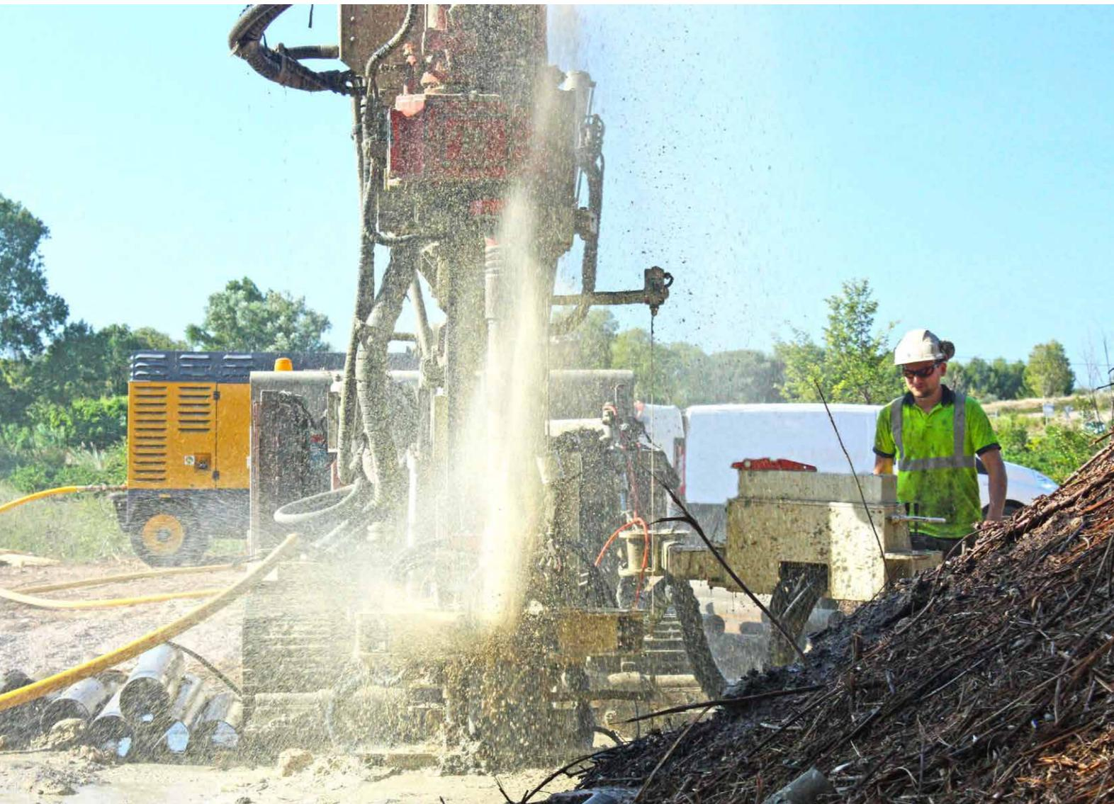
La linea GEO comprende un vasto ventaglio di modelli installati su carro cingolato, che vanno dalle unità leggere e ultra-compatte per l'esecuzione di piccoli pozzi in aree residenziali caratterizzate da spazi ridotti, fino alle macchine con classe di peso fino a 35 ton.
