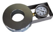
K Kraftmessdose 600kN Manometer
