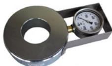
**K Kraftmessdose 600kN Manometer**
