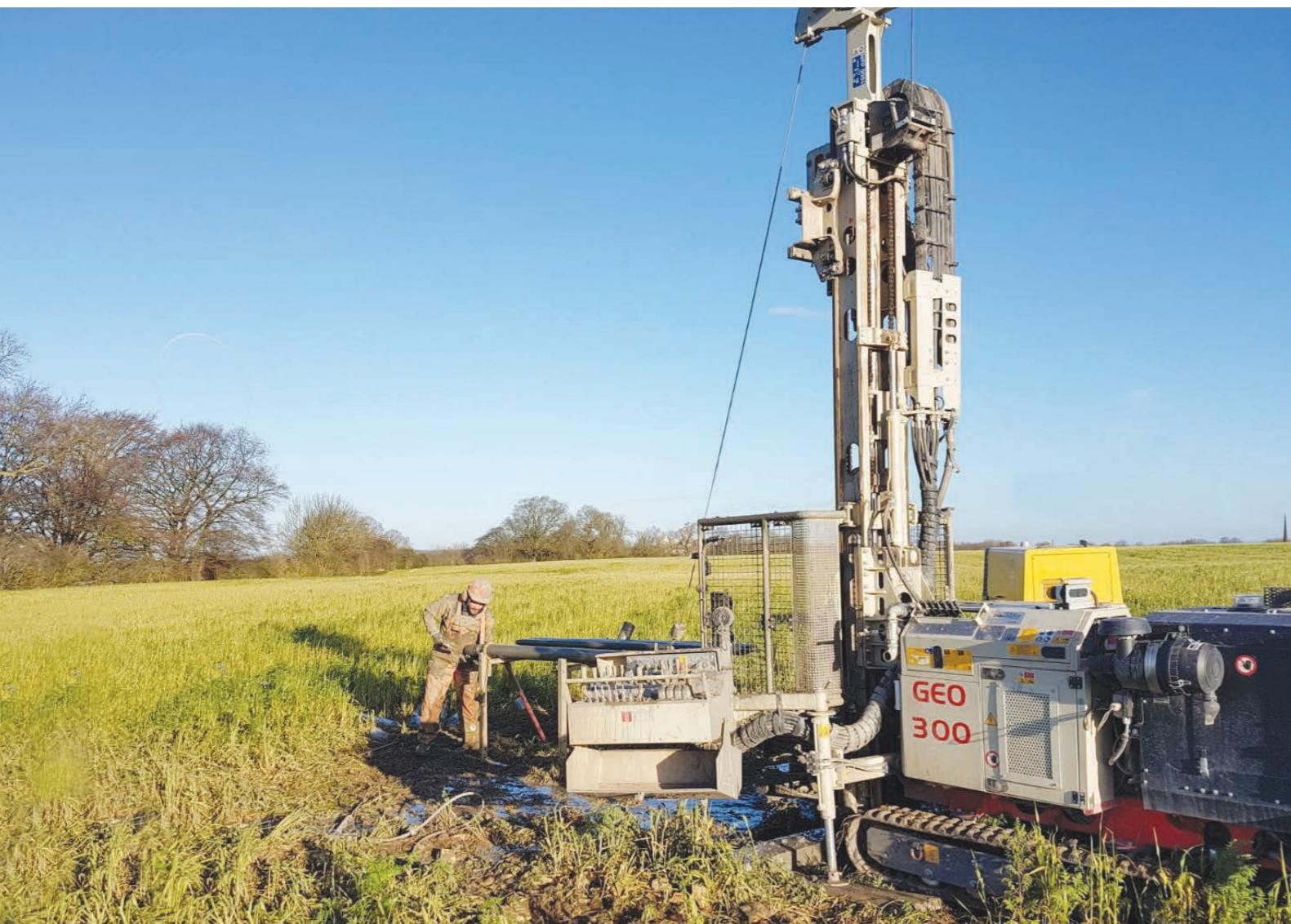
La linea GEO comprende un vasto ventaglio di modelli installati su carro cingolato (in acciaio o in gomma), che vanno dalle unità leggere e ultra-compatte per l'esecuzione di piccoli carotaggi anche all'interno di edifici o in spazi ridotti e di difficile accesso, alle soluzioni eli-trasportabili, fino alle macchine con classe di peso fino a 22 ton.
