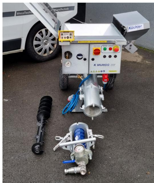
● Exzenter-Schneckenpumpe EP
