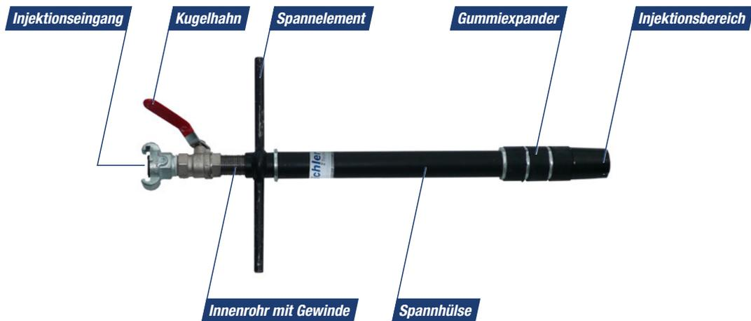
Der **K Schraubpacker** eignet sich hervorragend für Injektionen mit Mörtel oder Zement. Der Vorteil liegt im Mehrfacheinsatz und im schnellen Versetzen.
