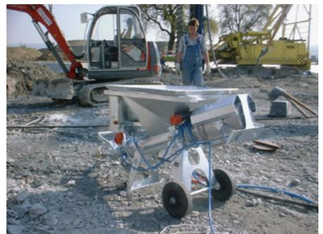
**K MUNG®** Injektionsanlage max. 70 bar Injektionsdruck
