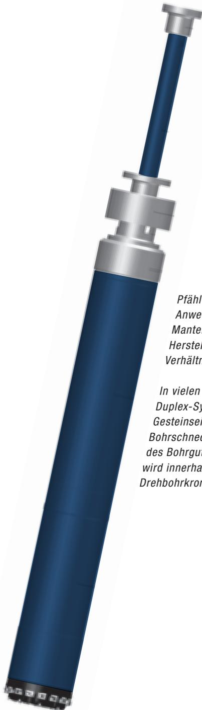
*Pfähle mit kleinem Durchmesser sind für unterschiedliche Anwendungen vorgesehen. Sie leiten ihre Lasten über Mantelreibung in den tragfähigen Untergrund ein. Für die Herstellung können kleine Bohrgeräte auch unter beengten Verhältnissen eingesetzt werden.*
