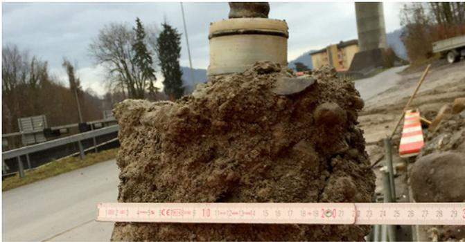
230mm nomineller Durchmesser mit 100 mm Bohrkronengrösse
