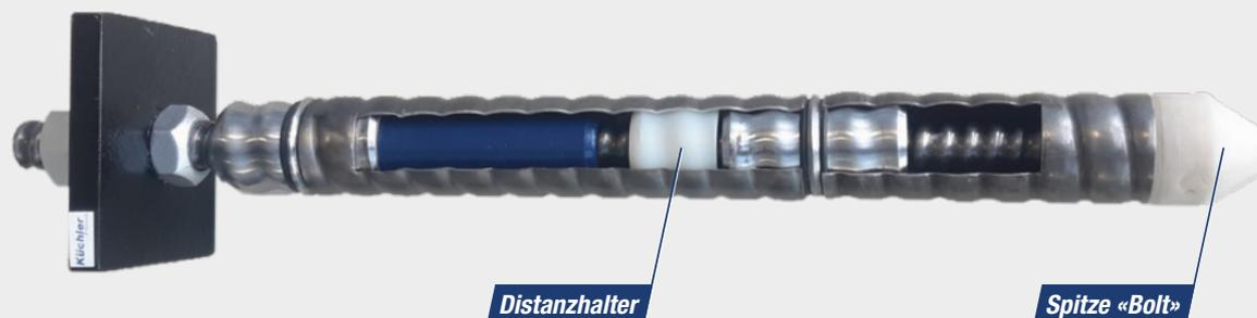
Das **KÜPS®** (Küchler Permanent System) besteht aus einem **KSB®** (wahlweise R32 / R38 / R51 / T64) Zugglied und einem Hüllripprohr (wahlweise 60/76/90), das die unbeschädigte Einbettung des Zugglieds durch **KÜMIX®** (Injektionsgut) sicherstellt.
