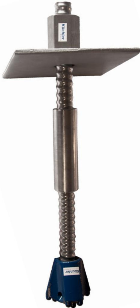
Der **KSB®** INOX ist ein selbstbohrendes Ankersystem mit durchgehendem Aussengewinde, das ohne Verrohrung in lockere Böden und Fels bei gleichzeitigem Verpressen eingebohrt werden kann. Der Anker verfügt zudem über ein linksgängiges Gewinde für herkömmliches Drehschlagbohren.
