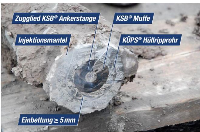
Muffe mit doppeltem Korrosionsschutz nach SIA Norm. Entwickelt und geprüft mit der FH Bern, Burgdorf und mit einem KTI Projekt erfolgreich abgeschlossen.
