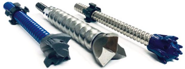
**KÜPS®** Küchler Permanent System-Bodennägel sind ideal für lose oder instabile Böden, da sie ohne Verrohrung eingebracht werden können. Das System wird daher gerne bei nicht standfesten Böden verwendet. Das **KÜPS®** ermöglicht Bohren und Injizieren in einem Arbeitsgang. Der vollständige Verbund auf ganzer Länge ermöglicht die Verdübelung des oberflächlichen, losen Erdkeils mit einer tiefer gelegenen Bodenschicht. Bodennägel werden normalerweise als risikoarme Einbauten angesehen.
