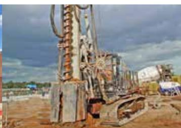
Le perforatrici Comacchio della linea CH sono progettate per l'esecuzione di pali di grosso diametro. Tutte le macchine CH sono unità automontanti e multifunzione: i vari modelli possono essere forniti in versione con tiro-spinta ad argano o a cilindro, in versione kelly, CFA, DP (Displacement pile) o Soil Mixing. La gamma comprende anche delle unità dedicate per la tecnologia CFA.
