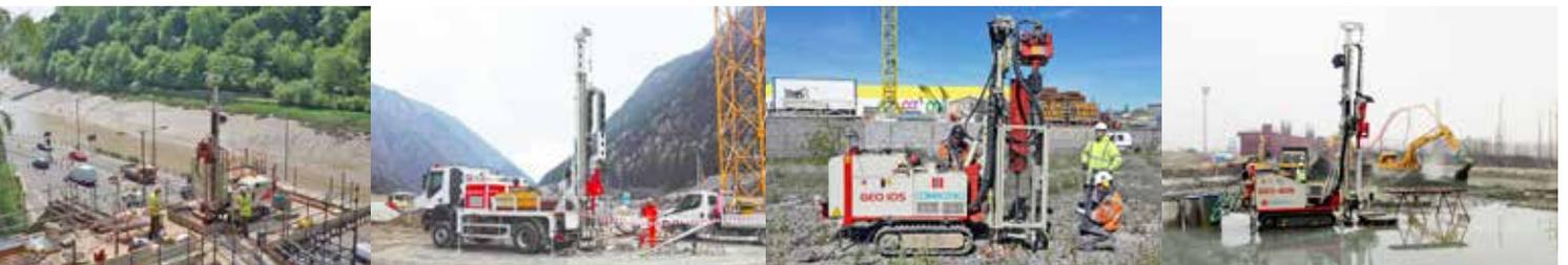
La linea GEO è studiata per il settore delle indagini geognostiche e del monitoraggio ambientale. Con 15 modelli su cingolo o su camion, comprende sia unità leggere e compatte, adatte all'esecuzione di piccoli carotaggi all'interno di edifici o in spazi ridotti e di difficile accesso, sia macchine di classe di peso fino a 22 ton utilizzate anche per la realizzazione di pozzi per acqua o geotermici.
