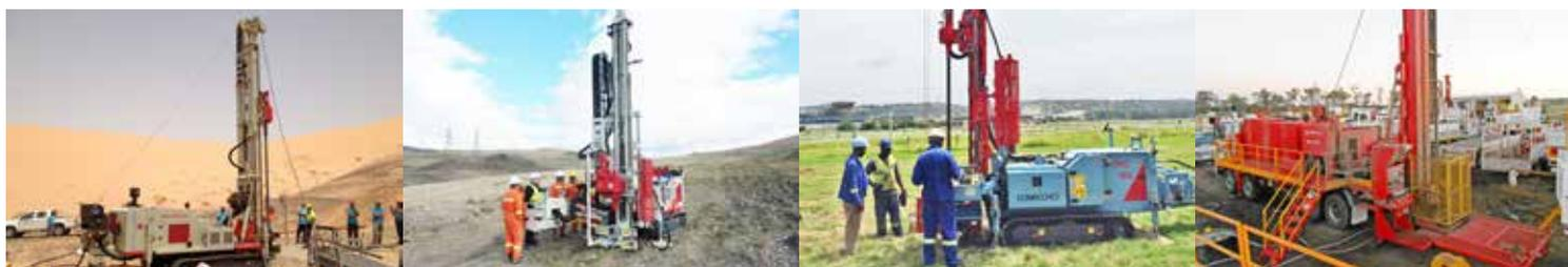
All'interno della linea GEO Comacchio ha sviluppato una serie di perforatrici concepite per il settore minerario. Queste macchine consentono di effettuare carotaggi continui a elevate profondità con l'utilizzo del sistema wire line e l'impiego di aste BQ, NQ, HQ e PQ e possono essere efficacemente impiegate per perforazioni a circolazione inversa, in grado di fornire campioni accurati in modo veloce ed efficace.
