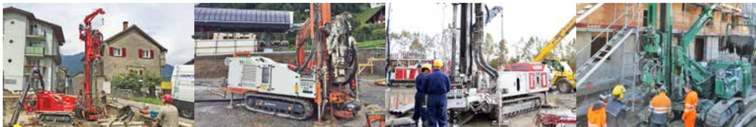
La gamma GEO GT per il settore di pozzi acquiferi e della geotermia è studiata per le applicazioni che utilizzano sistemi di perforazione a doppia testa. L'impiego di soluzioni innovative sia per quanto riguarda il trattamento dei detriti, sia per quanto riguarda la gestione automatizzata delle attrezzature di perforazione, consente di raggiungere elevati livelli di produttività e rendere i processi più semplici e sicuri per l'operatore.
