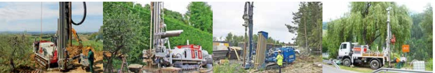
Le perforatrici Comacchio della linea GEO W sono unità multipurpose, in grado di soddisfare le esigenze legate al campo dell'idrogeologia, dei pozzi acquiferi e della geotermia. Le macchine, su cingolo o camion, sono in grado di sviluppare fino a 50 ton di tiro e di operare con testa singola con sistemi a circolazione diretta o inversa e DTH, in funzione del diametro, della profondità e tipologia del terreno.
