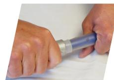
Fixation de la vanne et de la douille à sertir avec le tube à sertir K
