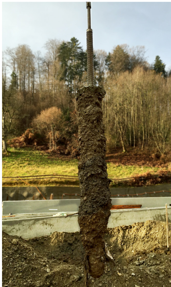
Système KÜPS® entièrement enrobé de KÜMIX® après extraction.
