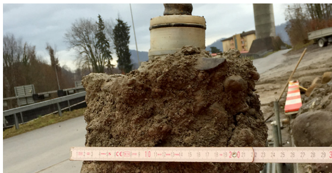
Diamètre nominal 230 mm avec diamètre de couronne 100 mm.
