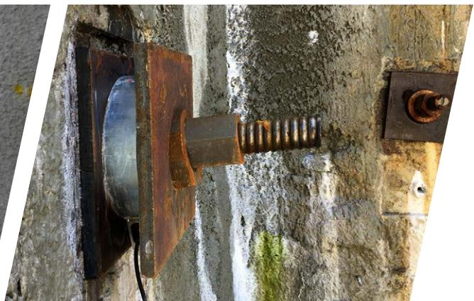
Einbau einer Kuechler Kraftmessdose. Der Anker wird mit Spannung auf seine Widerstandsfähigkeit geprüft. Die Kraftmessdose dient zur periodischen Ablesung der wirkenden Kräfte.
