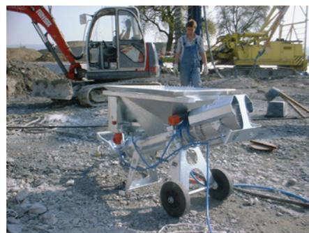
**K MUNG®** installation d'injection pression d'injection max. 70 bars
