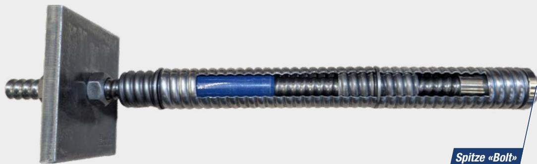
Das **KÜPS®** (Küchler Permanent System) besteht aus einem **KSB®** (wahlweise R32 / R38 / R51 / T64) Zugglied und einem Hüllripprohr (wahlweise 60/76/90), das die unbeschädigte Einbettung des Zugglieds durch **KÜMIX®** (Injektionsgut) sicherstellt.
