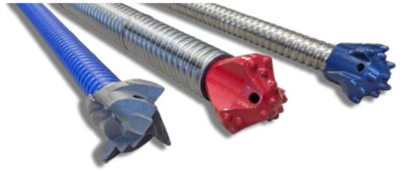
**KÜPS®** Küchler Permanent System-Bodennägel sind ideal für lose oder instabile Böden, da sie ohne Verrohrung eingebracht werden können. Das System wird daher gerne bei nicht standfesten Böden verwendet. Das **KÜPS®** ermöglicht Bohren und Injizieren in einem Arbeitsgang. Der vollständige Verbund auf ganzer Länge ermöglicht die Verdübelung des oberflächlichen, losen Erdkeils mit einer tiefer gelegenen Bodenschicht. Bodennägel werden normalerweise als risikoarme Einbauten angesehen.
