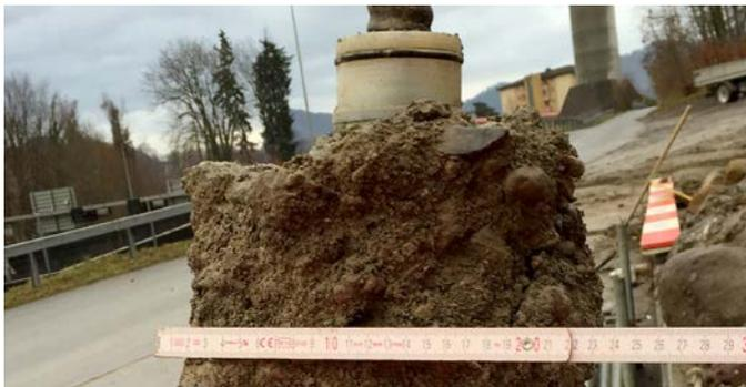
230mm nomineller Durchmesser mit 100 mm Bohrkronengrösse
