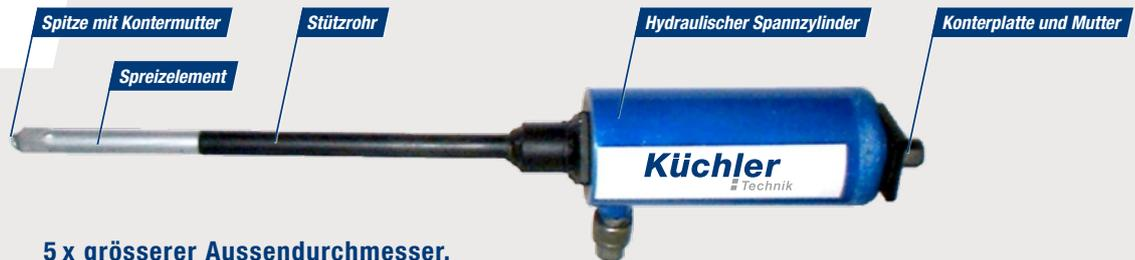
**Funktion** 5 x grösserer Aussendurchmesser, max. Belastung 50 kN auf Zug
