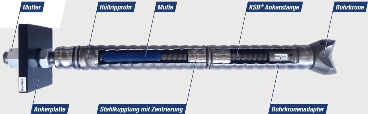
Das **KÜPS®** (Küchler Permanent System) besteht aus einem **KSB®** (wahlweise R32 / R38 / R51 / T64) Zugglied und einem Hüllripprohr (wahlweise 60/76/90), das die unbeschädigte Einbettung des Zugglieds durch **KÜMIX®** (Injektionsgut) sicherstellt.
